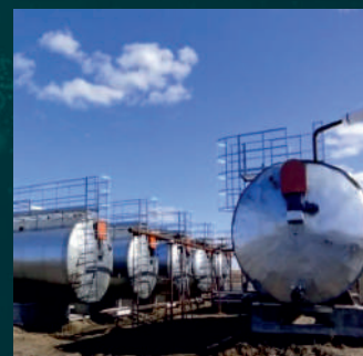
Амурская область Мод. СБГ-50, навоз КРС, биогаз на получение тепловой и электрической энергии, эффлюент круглогодично вносится на поля
