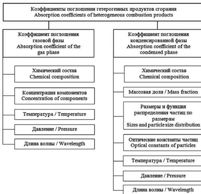
Рис. 2. Основные факторы, определяющие коэффициенты поглощения гетерогенных продуктов сгорания
