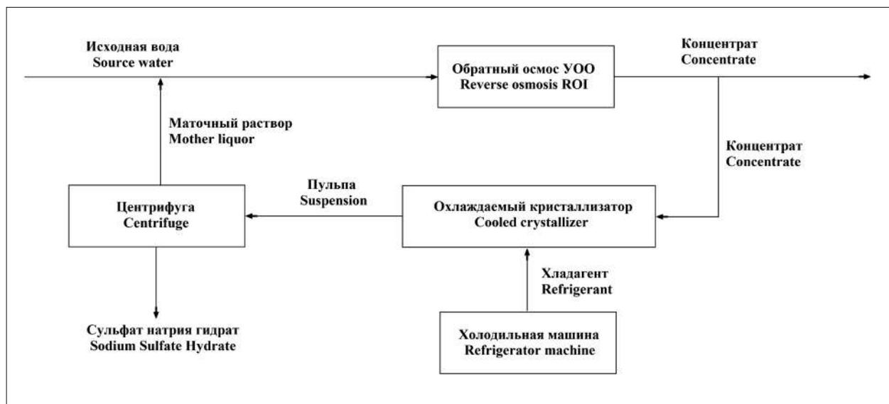
Рис. 1. Технологическая схема кристаллизации мирабилита
